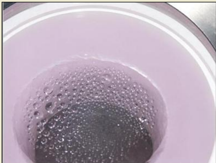
Получение эмульсионного слоя в вихревом эмульгаторе
