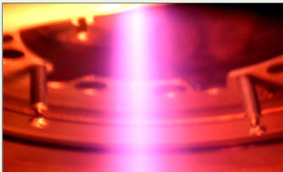
Свечение атомов ( p \sim 10^{-2} тор) при прохождении пучка ускоренных ионов H^-
