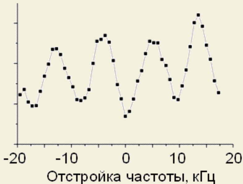
Рис.1 Резонансы Рамси в разнесенных во времени лазерных полях при взаимодействии с охлажденными и локализованными в магнитооптической ловушке атомами магния.
