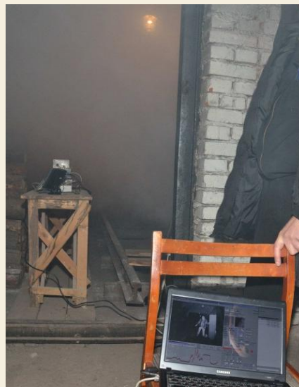
Изображение спасателей в конце задымленного тоннеля на удалении 20 м (а) и реальное изображение тоннеля со степенью задымленности 4 балла.
